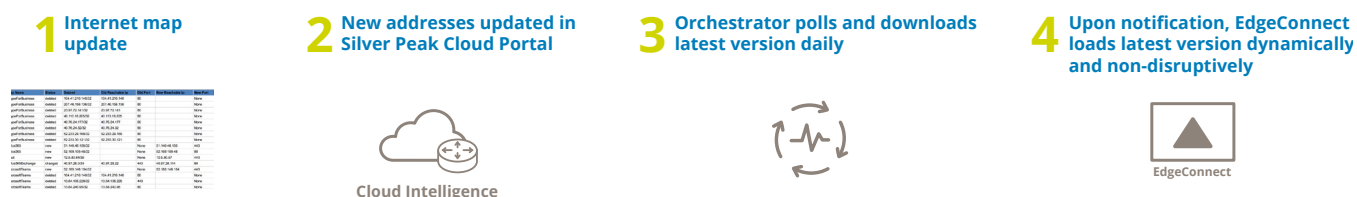
図 3：アプリケーション IP アドレスデータベースは毎日すべての EdgeConnect 機器に更新されます。
